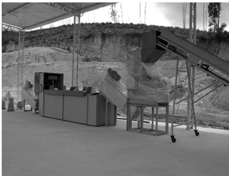
*Ilustração do processo de instalação dos equipamentos adquiridos pelo projeto para a moagem dos plásticos.*
